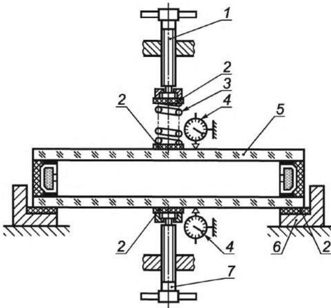
1 — верхний нагрузочный винт; 2 — прокладка; 3 — пружина; 4 — индикатор часового типа; 5 — стеклопакет;
